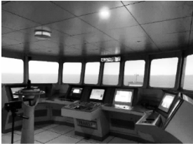
图 1 船舶操纵模拟器
